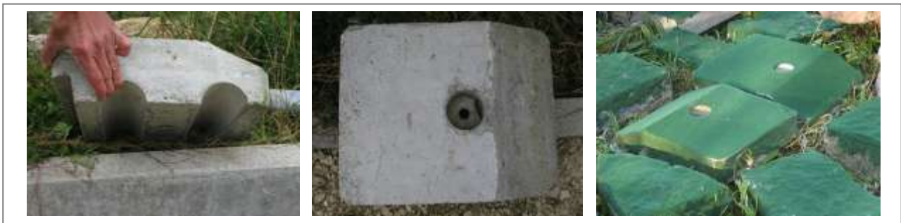
Abbildung 2: Betonstein mit zur Strömung hin abgeflachter Seite, Hohlräume als Unterstand und Vertiefung zum Einschrauben der Mutter (links und Mitte). Beflockte Störsteine (rechts).
