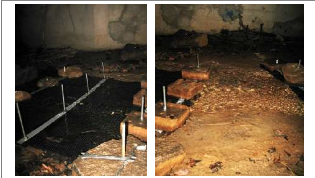
Abbildung 7: Beprobungsstelle in der Verdolung im Erlenbach, April 2011. Links der Beprobungsabschnitt mit Abstandsgewebe, rechts der Vergleichsabschnitt ohne Textil und ohne Störsteine.
