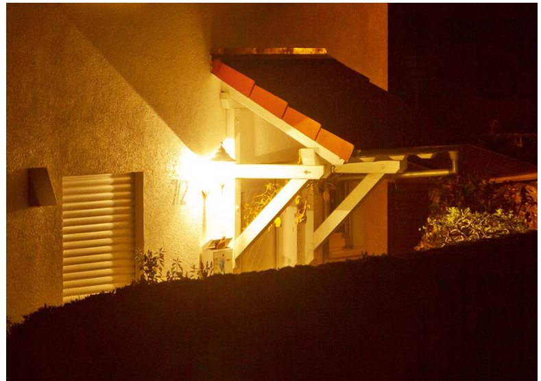
oben: Die nicht abgeschirmte Leuchte gibt das meiste Licht sinnlos nach oben und zur Seite ab.
