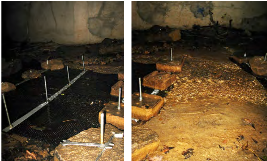
Abbildung 7: Beprobungsstelle in der Verdolung im Erlenbach, April 2011. Links der Beprobungsabschnitt mit Abstandsgewebe, rechts der Vergleichsabschnitt ohne Textil und ohne Störsteine.
