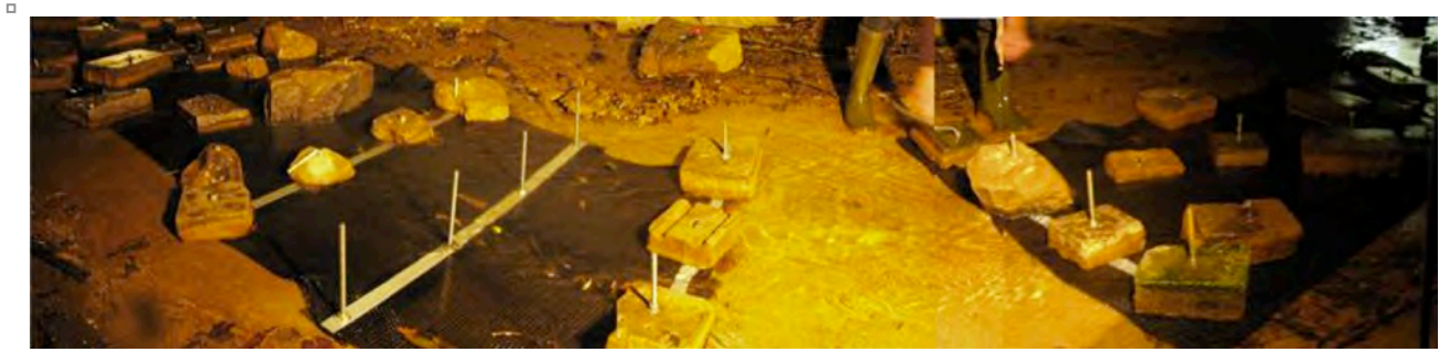
Abbildung 3: Beprobungsstelle im Erlenbach. Am linken und rechten Bildrand sind die Störsteine auf dem eingebrachten Textil zu erkennen. Links Die Gewebe-Beprobungsstellen ohne Störsteine, daneben die Vergleichsstelle ohne Textil oder Steine.
