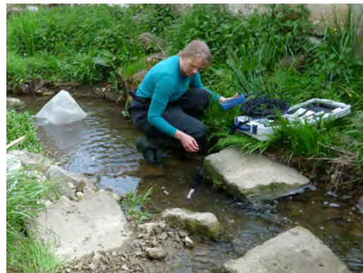
Abbildung 4: WTW Multiparameter Sonde (WTW Multi Handgerät 350i mit WTW MPP 350 Multielektrode, WTW, Weilheim Germany), Leihgabe der Abteilung Zoologie, Universität Stuttgart (links). Messproben am Erlenbach (rechts)
