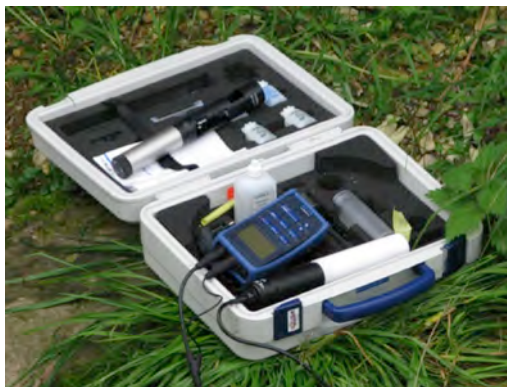
Abbildung 4: WTW Multiparameter Sonde (WTW Multi Handgerät 350i mit WTW MPP 350 Multielektrode, WTW, Weilheim Germany), Leihgabe der Abteilung Zoologie, Universität Stuttgart (links). Messproben am Erlenbach (rechts)
